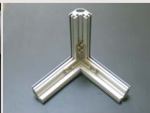
事例 1 の接合形状 メインフレームのコーナー継ぎ目 (内側)
